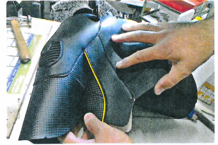
Die Thanner GmbH in Höchstädt brachte nach der Fertigung des Leistens und der Kopieeinlage durch die Firma Frohnhäuser die individuelle Brandsohle auf den Leisten auf. Da die Schuhe aus einem Microfaser-Obermaterial und einem abriebfesten und atmungsaktiven Futtermaterial aus Abstandsgewirk hergestellt wurden, konnte das Gewicht des Schuhs deutlich reduziert werden.
